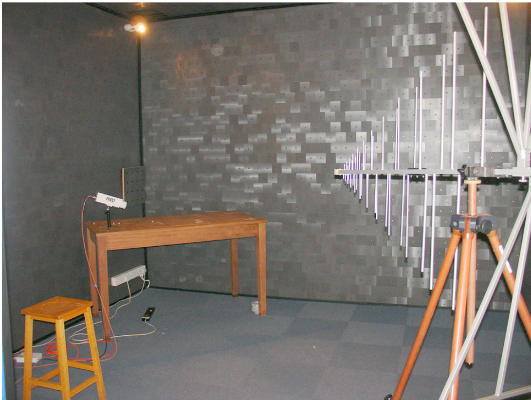
EMC-prov utförs i skärmrum. Provobjektet ska ställas på träbordet och mätantennen står till höger. Bild: Stan Zurek, CC BY-SA 3.0
